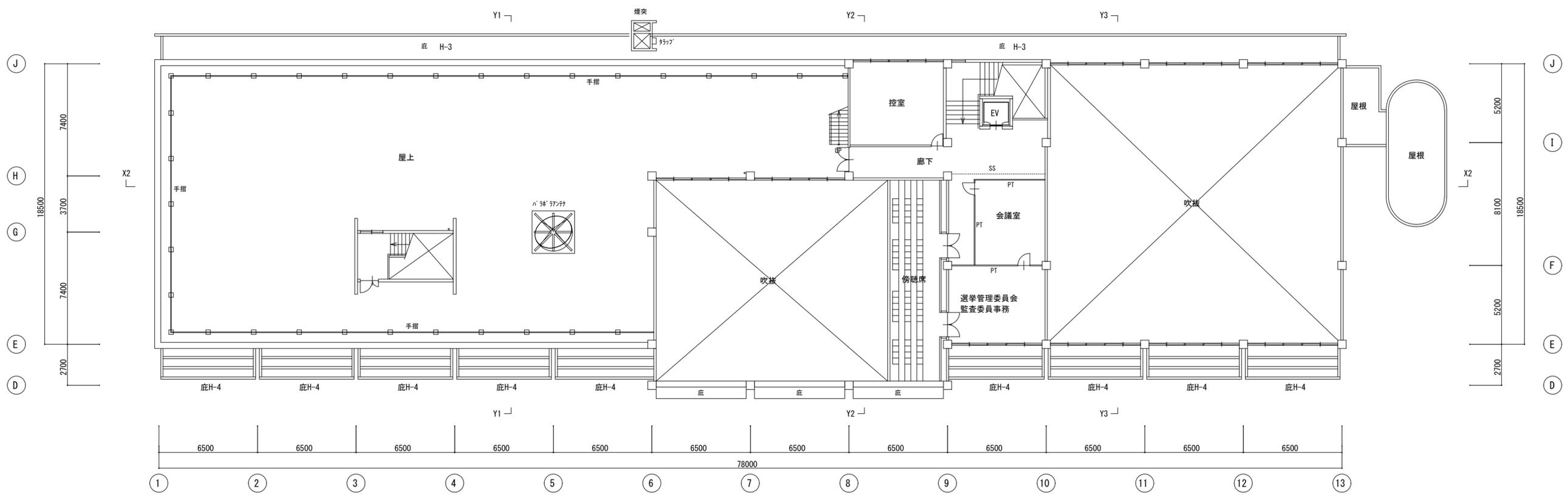
既設4階平面図 1/200 凡例 鉄筋コンクリート LGS間仕切 PT パーティション SS シャッター
