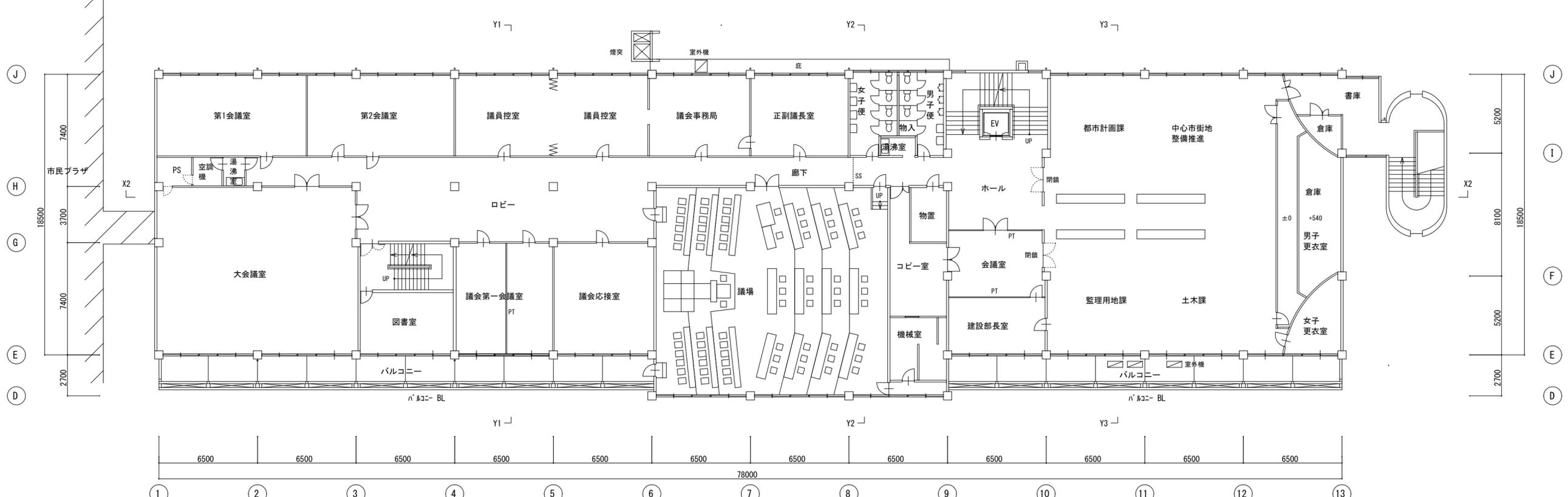
既設3階平面図 1/200 凡例 鉄筋コンクリート LGS間仕切 PT パーティション SS シャッター
