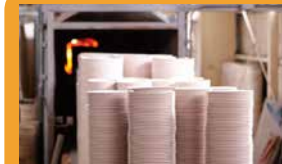
約800℃で6~8時間 粘土の水分を抜くため に焼く。吸水性が高まり 施釉がしやすくなる。
