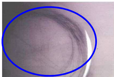
釉面に発生した、黒っぽい筋状の汚れ
