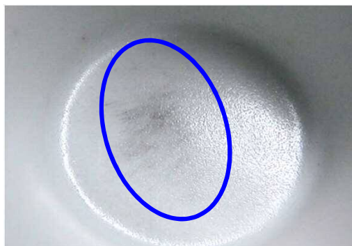
釉面に発生した、黒っぽい筋状の汚れ
