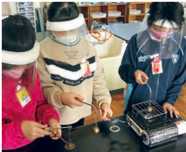
金属球を加熱して膨張を調べる実験の様子
