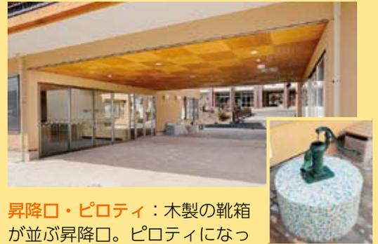
**昇降口・ピロティ**：木製の靴箱が並び昇降口。ピロティになっており橋を渡って中学校へ行くことができます。エコスクールの取り組みとして、校舎の下に雨水を貯めるタンクを設置。手押しポンプで水を汲み上げて花壇の水やりなどに利用します。
