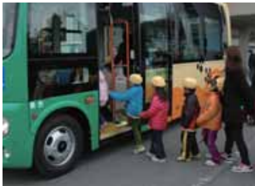
◀黄瀬戸号（ノンステップバス）の乗り口。路面から1段で車内に乗ることができる。
