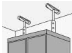
天井と家具の間にストッパーを設置し固定する。
