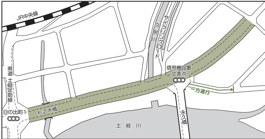
中心市街地活性化の柱の一つとして進めている新土岐津線（県道河合多治見線）の拡幅改良について、その一部が土岐川復繋関連事業により、今年三月末（予定）に完成します。完成するのは左図に示した緑色の区間約300mで、両側に歩道を備えた幅員十七mの県道として生まれ変わります。
