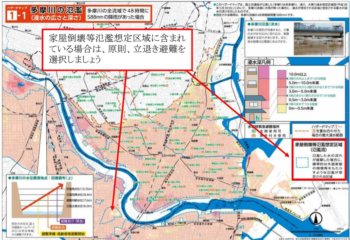
図 6 家屋倒壊等氾濫想定区域を示した洪水ハザードマップの例
