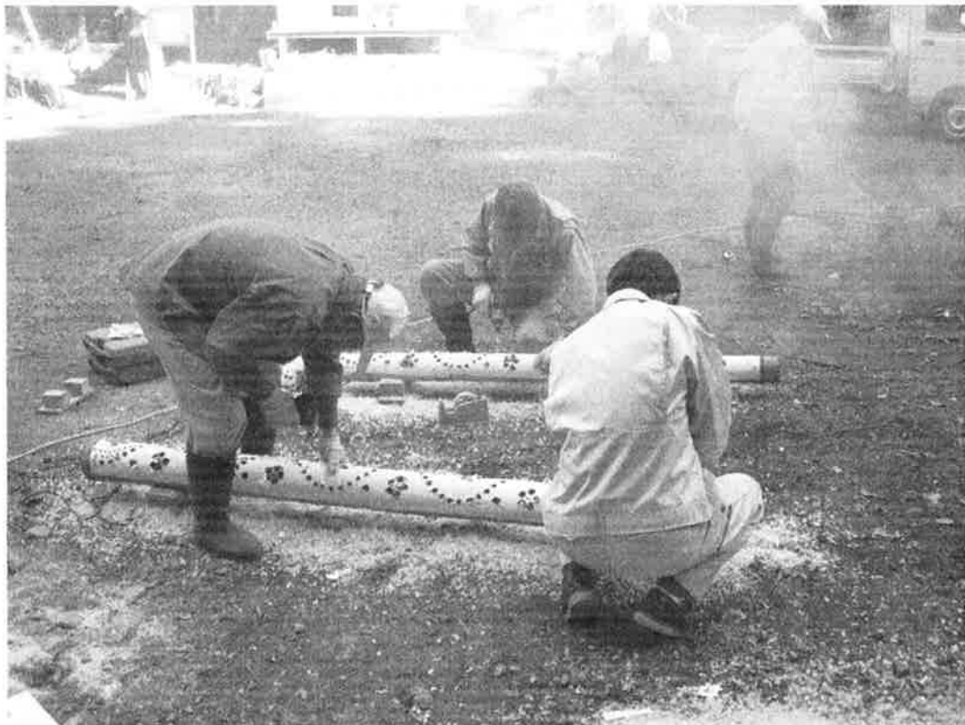
パターンを印刷した紙を竹に張付け、ドリルで穴あけ作業
