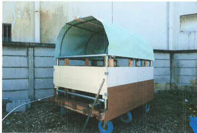
開閉式シート製屋根と6輪のチューブレスタイヤ
