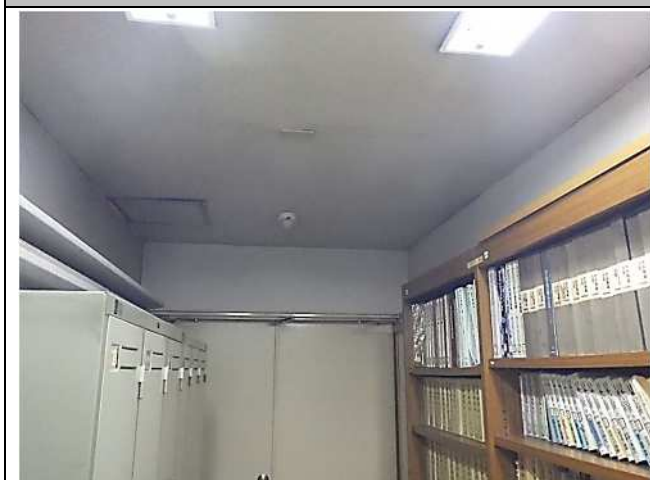
天井：ボード+クロス、壁：ゾラコート吹付
