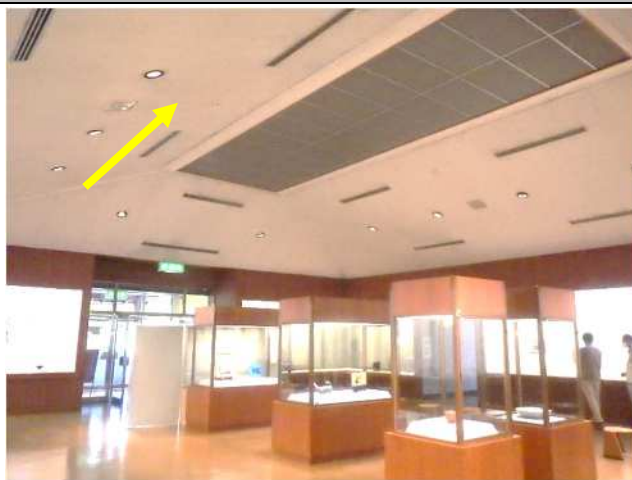
天井(CH～4950)：岩綿吸音板+PB
