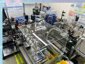
開発中の超小型加速器質量分析装置
