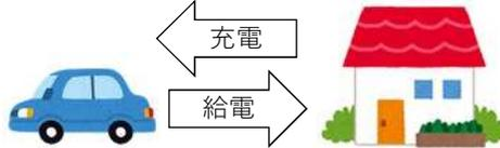
電気の流れが双方向になっているため、災害時の非常用電源を確保できます
