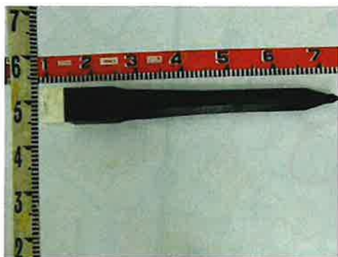
（基準点用 プラスチック杭） サイズ 6cm×6cm×60cm
