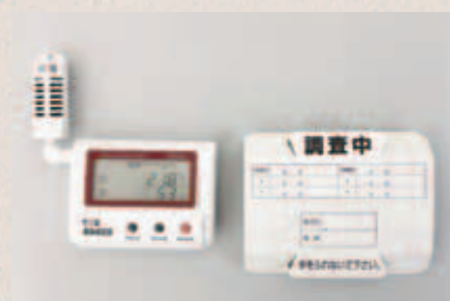
博物館で資料を守るための用具 温湿度記録計(左)と捕虫トラップ(右)
