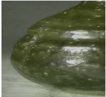
有機物燃焼によるガス発生 にと思われるピンホール
