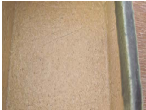
熔ける成分が少ないため、 釉のツヤが足りない例
