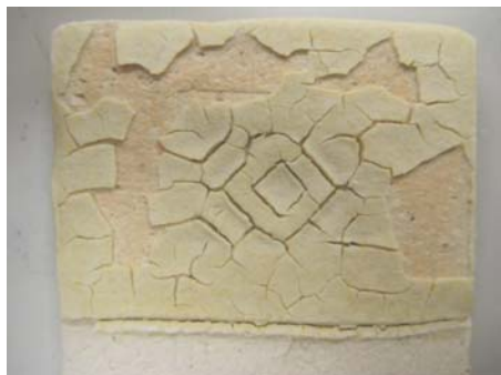
釉に粘り成分が足りず、焼成後に釉がめくれたテストピース
