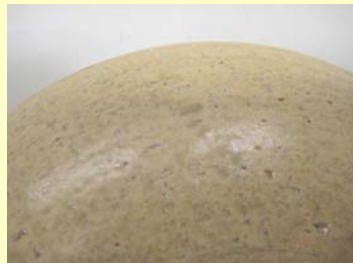
釉の攪拌が不十分で濃度の薄い釉がかかってツヤ不足となった例
