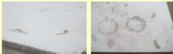
付着物、アルミナ剥れによって凹凸が生じた棚板
