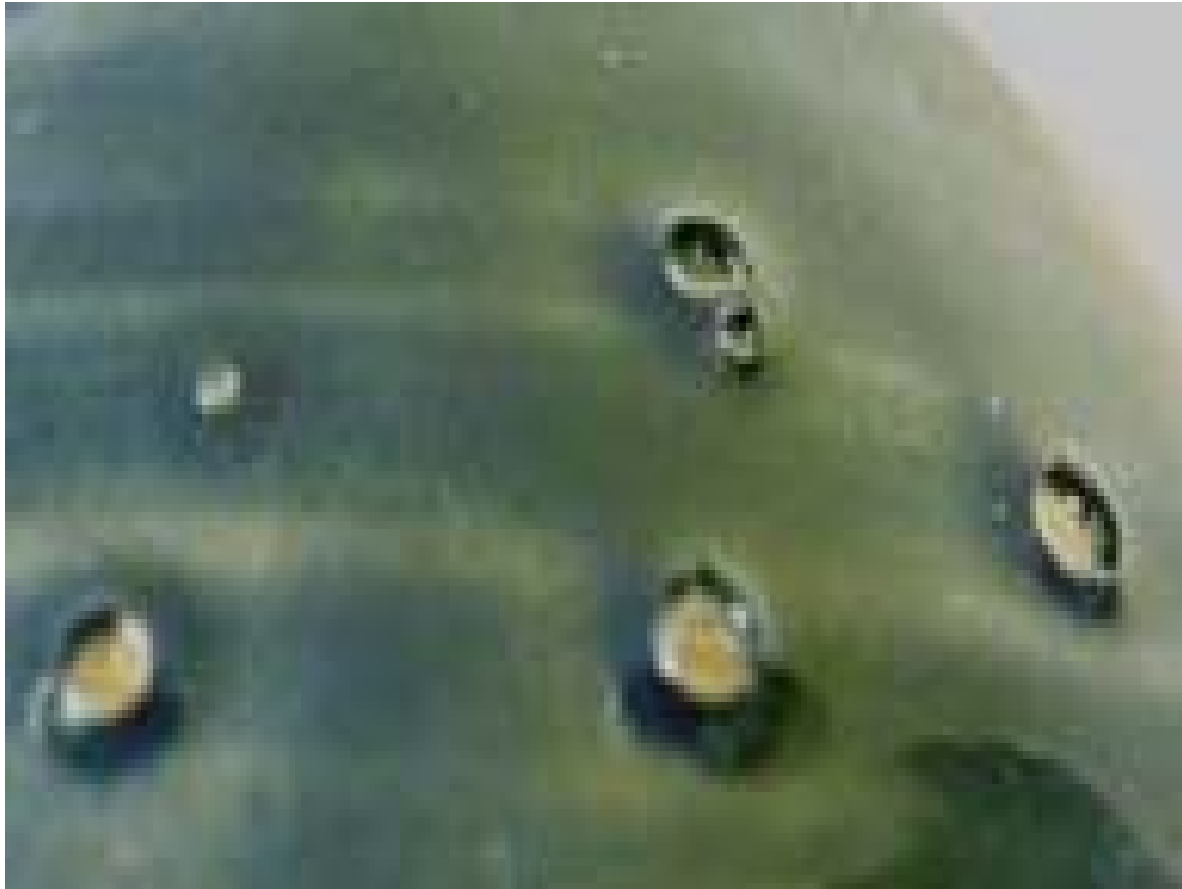
釉面に発生したぶくの例
