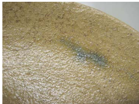
粗い石英が熔け残り、ツヤ不足となった例
