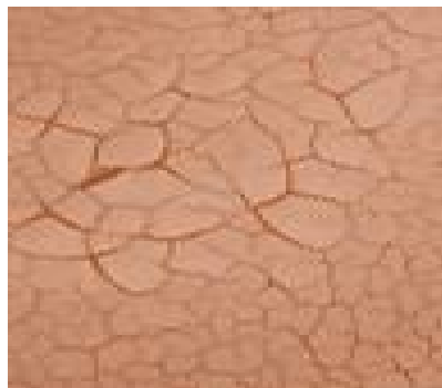
釉の乾燥収縮が大きく、 釉メクレが発生した例
