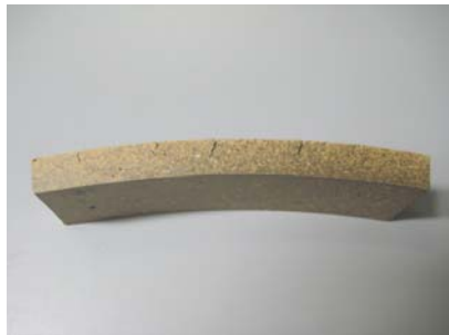
焼成後に反りを生じた例 (半乾式プレス成形)
