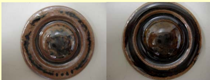
釉が薄すぎ、鉄釉が十分に発色しなかったテストピース(左)
